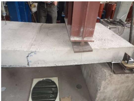
Figura 6. Vista da laje mista após colapso
