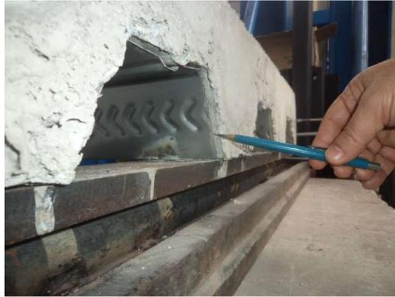
Figura 13. Detalhe do deslocamento horizontal relativo entre a fôrma de aço e o concreto.
