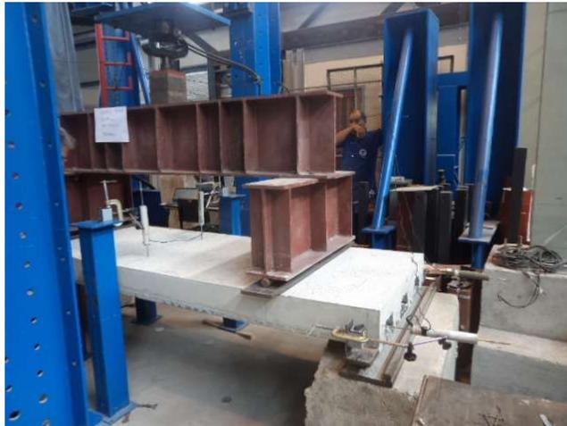
Figura 2. Posicionamento dos transdutores de deslocamento
