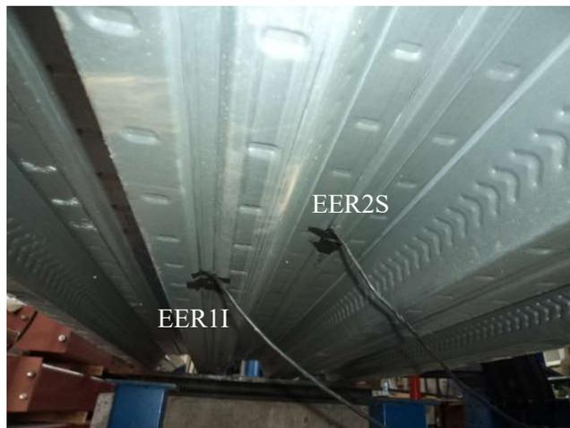
Figura 3. Posicionamento dos extensômetros elétricos de resistência
