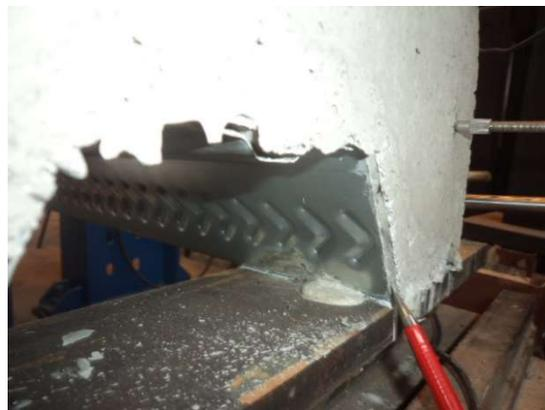
Figura 5. Seção transversal após colapso
