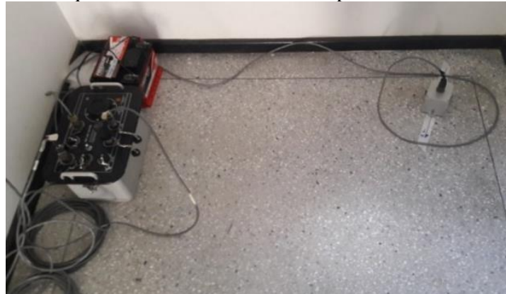
Figura 3. Detalhe da estação sismológica e do acelerômetro triaxial fixado no piso
