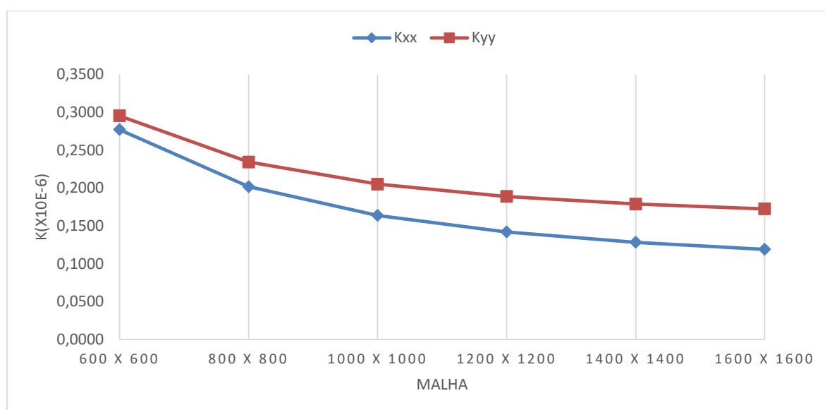
Figura 8. Convergência do resultado da permeabilidade 2-D de uma amostra de arenito.
