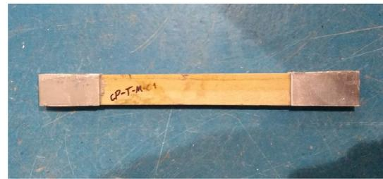
b) Tensile test specimens
