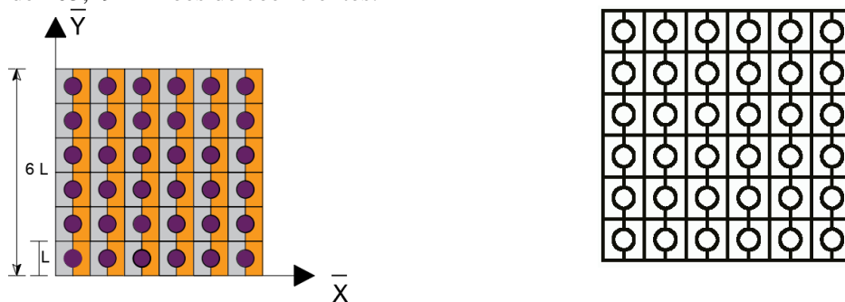
a). Seção transversal do compósito estudado b). Malha acoplada de elementos de contorno
