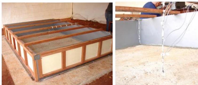
Figura 1. Forma da laje ensaiada e termômetros de monitoramento acoplados à plataforma LYNX (COPPE/FURNAS)
