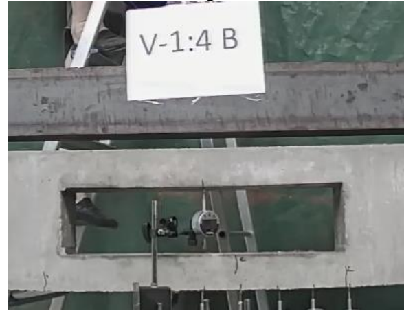
Figura 17. Formación de fisuras por flexión local
