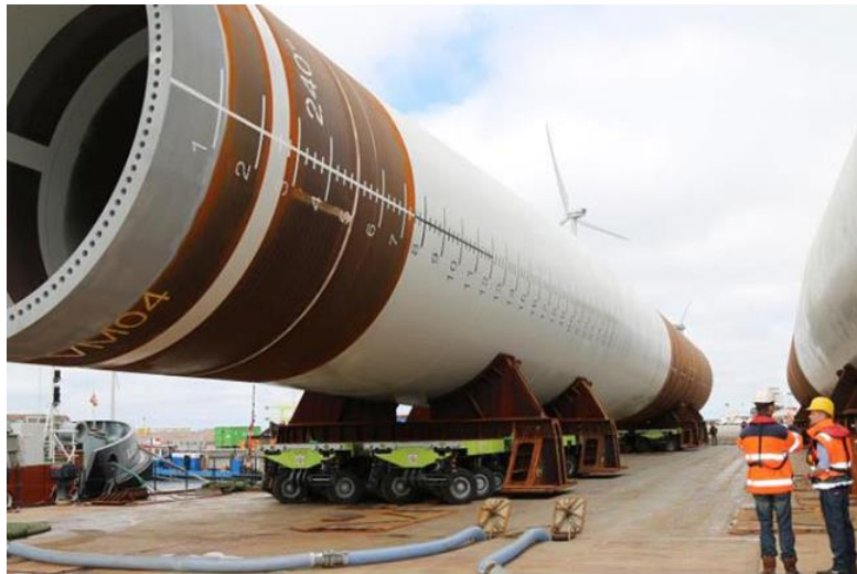
Figura 1. Monopile com diâmetro de 7,8 metros e comprimento de 84,5 metros produzida pela EEW Special Pipe Constructions GmbH (EEW) em Rostock (Alemanha)
