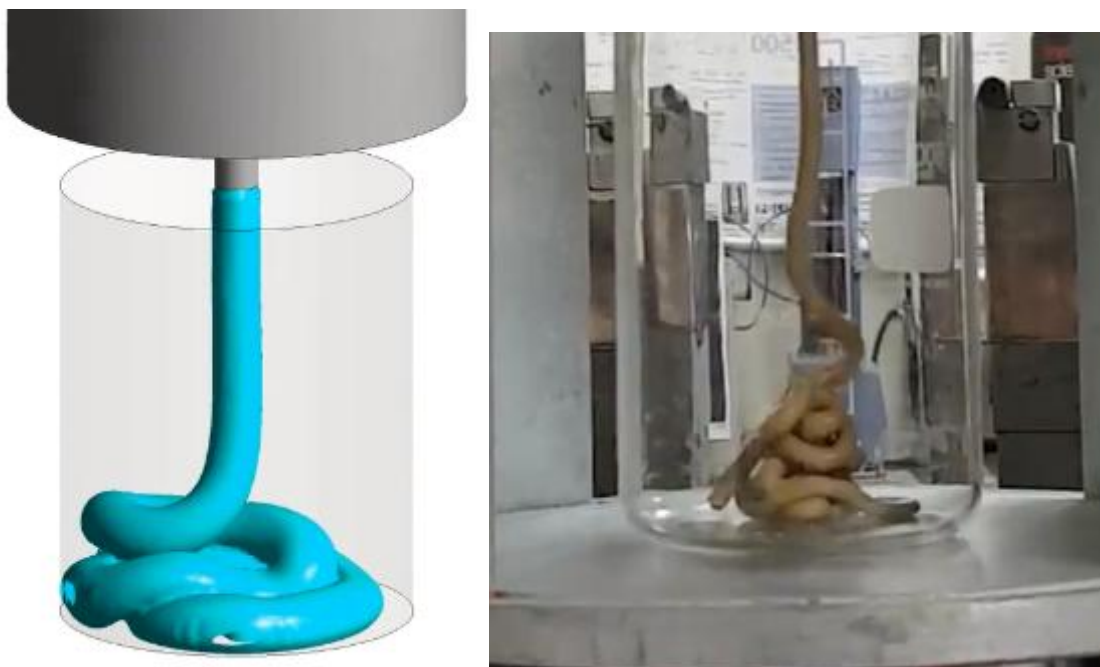
Figura 8. Comparação da simulação numérica com o ensaio realizado
