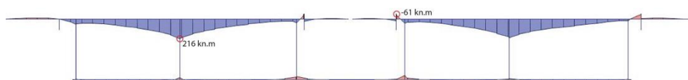
Figura 5. Diagrama de momentos fletores máximos (+) e mínimos (-) da viga de cobertura VT1-SAP 2000. (ENV. ELU). (Fonte: Autoral).
