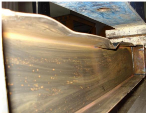
Figure 8. Modos de ruptura do modelo experimental
