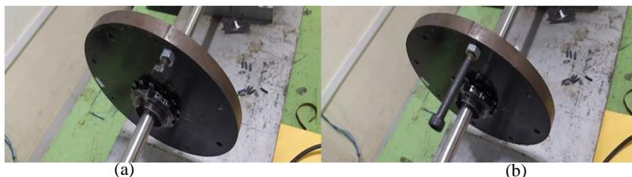
Figura 3. Massas desbalanceadas inseridas no disco. (A) 9 gramas e (B) 17 gramas
