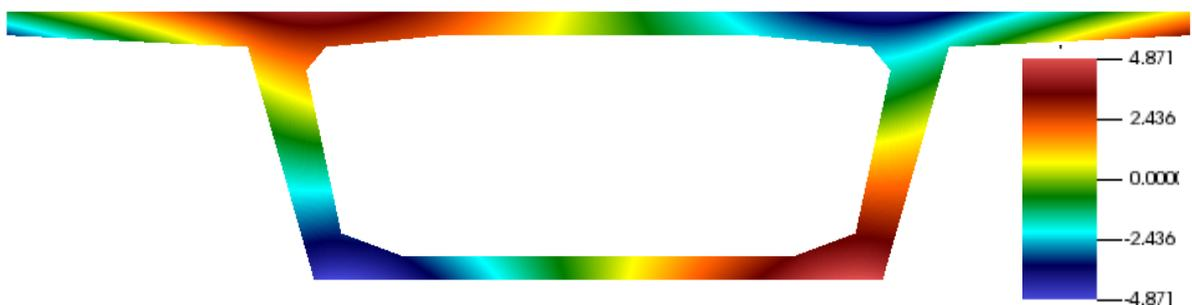
Figura 09 - Empenamento primário da seção transversal do exemplo 01.
