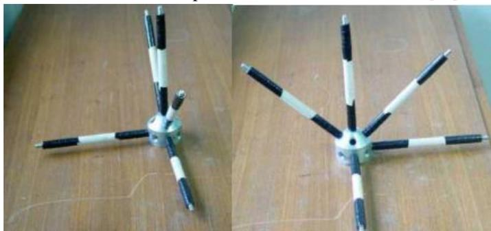
Figura 1. Exemplo de roseta de deformímetro [10].
