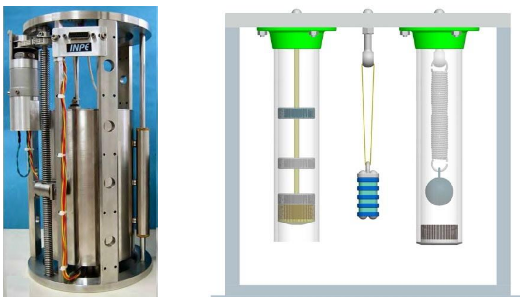
Figura 1: Exemplos de experimentos em microgravidade. Painel esquerdo: forno para investigar a influência da gravidade na solidificação de uma liga eutética de Pb-Sn nas posições de lançamento e microgravidade. Painel direito: ilustração do experimento educacional de deslocamento por meio de sistema massa-mola.
