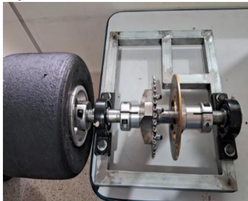
Figura 6 - Foto do sistema de transmissão.
