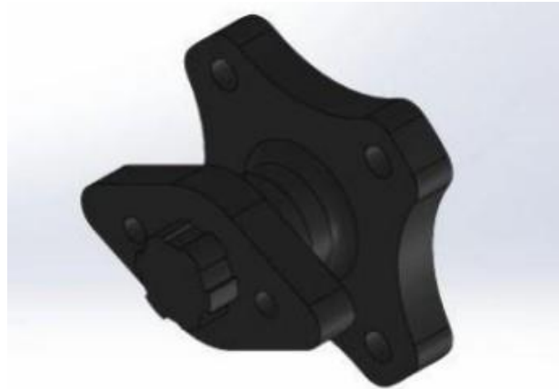
Figura 4 - CAD da peça que conecta a flange com o pinhão.
