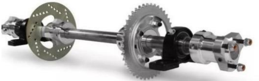
Figura 8 - sistema de transmissão de kart.
