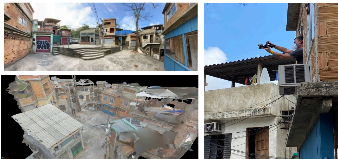
Figura 6: No topo, o cenário da telenovela Um Lugar ao Sol (2021-2022) a ser digitalizado. À direita, o registro de detalhes do ambiente para fotogrametria. Na parte de baixo, o resultado final do cenário digitalizado Fonte: Virtual, 2022.
