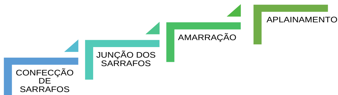
FIGURA 1: Etapas de fabricação do Compensado Sarrafeado.
