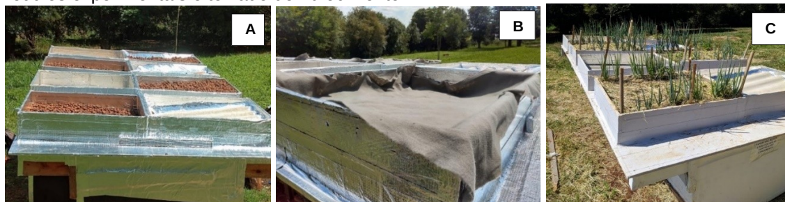
Figura 2: Procedimento de construção, vedação e implantação das coberturas de vegetação no ano 2: A) construção dos módulos experimentais; B) instalação da manta bidim e do substrato para implantação do telhado verde; c) bancada experimental com telhado verde com plantio das hortícolas nos módulos experimentais e telhado de fibrocimento.
