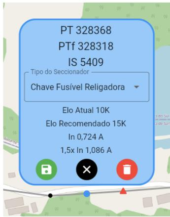
Figura 5: Exemplo de popup com as informações de uma seccionadora.
